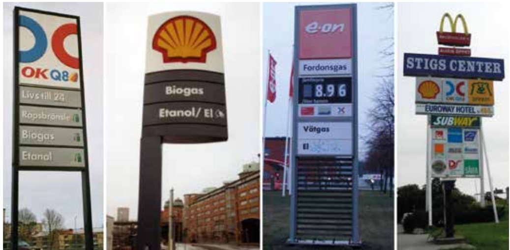
Esimerkkejä UE-monipolttoainemasista Ruotsissa: a) B100, CBG100 ja E85. b) CBG100, E85 ja UE-sähkö. c) CBG50, tuulivety ja tuulisähkö. d) LBG100, CBG100, B100, E85 ja SB35.
