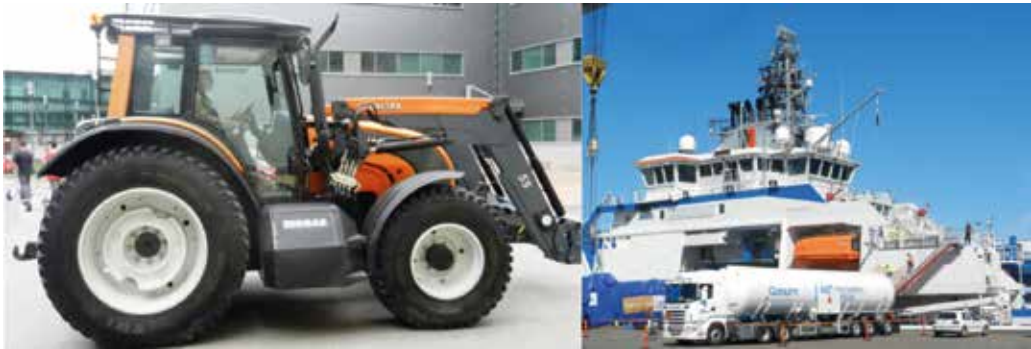
Suomessa valmistettuja metaaniajoneuvoja: a) Valtran biokaasutraktori. b) Rajavartiolaitoksen partiolaiva Turva, jota käytetään biokaasun sijaan maakaasulla.
