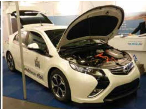
Polttoainejoustavia autoja Ruotsissa: a) Saab Trifueliin käy sekä biokaasu (CBG100) että etanoli (E85) ja bensiini. b) Malmön kaupungin ladattava hybridi käyttää tuulisähköä kaupunkiliikenteessä ja biokaasua maanteillä. Se on konvertoitu vaihtamalla Opel Amperan bensiinijärjestelmä metaanijärjestelmään.
