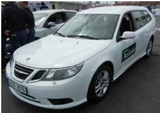
Polttoainejoustavia autoja Ruotsissa: a) Saab Trifueliin käy sekä biokaasu (CBG100) että etanoli (E85) ja bensiini. b) Malmön kaupungin ladattava hybridi käyttää tuulisähköä kaupunkiliikenteessä ja biokaasua maanteillä. Se on konvertoitu vaihtamalla Opel Amperan bensiinijärjestelmä metaanijärjestelmään.
