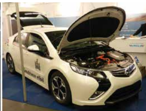
Polttoainejoustavia autoja Ruotsissa: a) Saab Trifueliin käy sekä biokaasu (CBG100) että etanoli (E85) ja bensiini. b) Malmön kaupungin ladattava hybridi käyttää tuulisähköä kaupunkiliikenteessä ja biokaasua maanteillä. Se on konvertoitu vaihtamalla Opel Amperan bensiinijärjestelmä metaanijärjestelmään.
